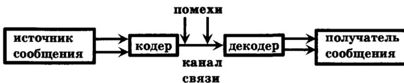
Рис. 10.6. Блок-схема канала связи
