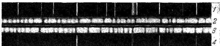
Рис. 10.26. Две спектрограммы двойной звезды \alpha^1 Близнецов, снятые в различные моменты времени. Только одна из двух звезд этой системы излучает свет, достаточно интенсивный для наблюдения. Заметьте, что линии спектра звезды сдвинуты относительно линий контрольного спектра, полученного в лаборатории, в различных направлениях соответственно двум стадиям движения звезды. В первой стадии звезда движется по направлению к Земле и частота света возрастает; во второй стадии звезда удаляется от Земли и частота уменьшается.
