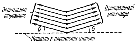
Рис. 9.18. Направления интерференционного максимума для антенн, возмущаемых с фазовыми соотношениями рис. 9.17.
