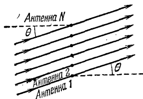
Рис. 9.17. Ряд антенн, возбуждаемых наклонно падающей волной.
