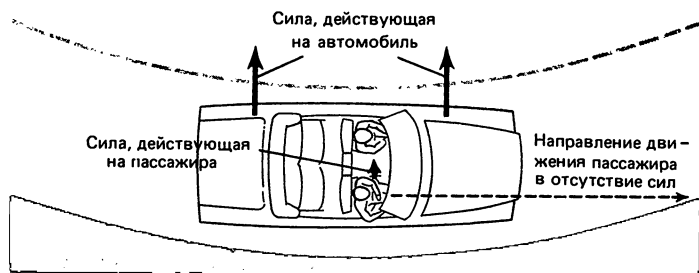
Рис. 5.4. Дорога создает силу, заставляющую автомобиль двигаться по окружности и направленную к ее центру. Аналогично автомобиль создает силу, действующую на пассажиров и также направленную к центру окружности.
