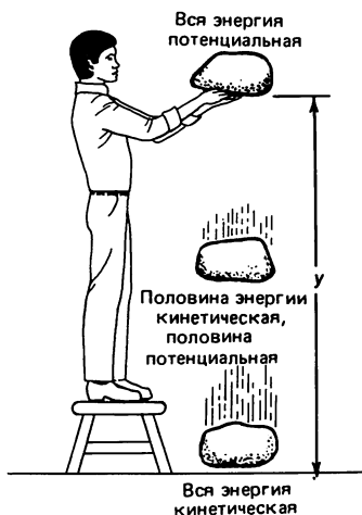
Рис. 7.2. При падении камня его потенциальная энергия переходит в кинетическую.
