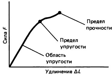
Рис. 11.9. Связь между силой и удлинением для твердого тела.
