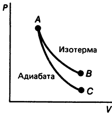
Рис. 20.4. PV -диаграмма адиабатического ( AC ) и изотермического ( AB ) процессов для идеального газа.
