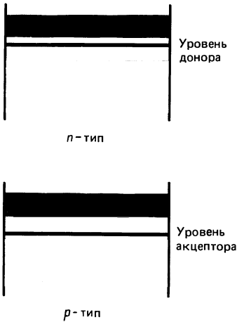
Рис. 41.21. Примесные уровни в легированных полупроводниках.
