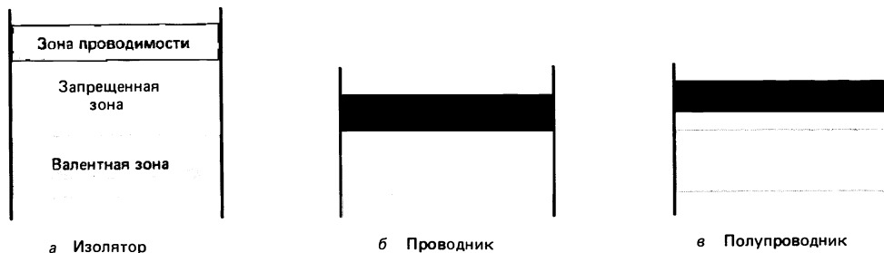
Рис. 41.20. Энергетические зоны в твердых телах. Показаны (в идеализированном виде) только зоны для внешних электронов. Зоны для других электронов соответствуют меньшей энергии.
