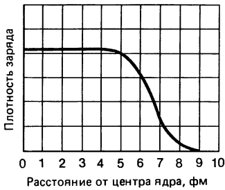
Рис. 43.1. Распределение электрического заряда в ядре висмута (по данным зондирования с помощью электронов с энергией 1,3 ГэВ).
