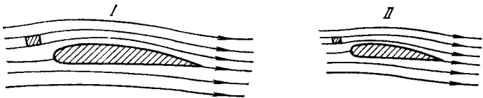
Рис. 3.1. Струйки и сходственные элементы в двух потоках, обтекающих геометрически подобные тела.
