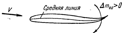
Рис. 3.74. Схема S-образного профиля. При возрастании угла атаки центр давления такого профиля перемещается в направлении к хвосту.
