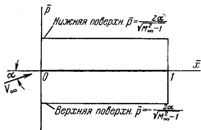
Рис. 5.85. Распределение давления по поверхности плоской пластинки, обтекаемой под углом \alpha линеаризованным сверхзвуковым потоком.
