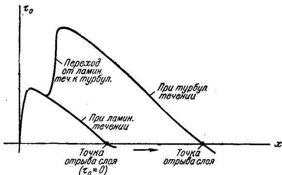
Рис. 7.47. При переходе от ламинарного течения в пограничном слое к турбулентному касательное напряжение на поверхности тела увеличивается и точка отрыва слоя перемещается по потоку.
