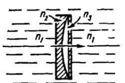
22-8. Тонкая стеклянная плосковогнутая линза, радиус кривизны которой  $R = 0,20$  м, плотно закрыта тонкой стеклянной пластинкой и погружена в воду (рис. 22-10). Определить оптическую силу такой системы.
