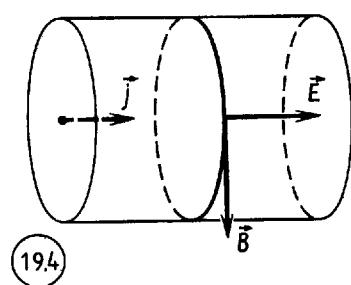
В этом случае ток идет как бы навстречу ЭДС, т. е. напряжение больше падения напряжения, электрическое поле производит джоулево тепло и преодолевает встречное стороннее поле.
