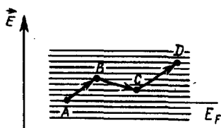
Рис. 13.7. Механизм прыжковой (перескоковой) проводимости. Ниже E_F состояния заняты электронами, выше — свободны (при T = 0 К); стрелками показаны три последовательных прыжка
