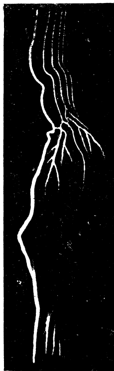
Рис. 178. Фотография искры на движущейся пленке.
