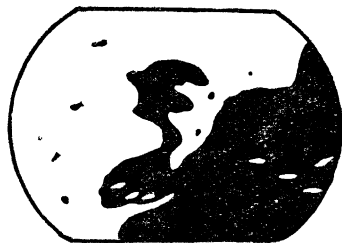
Рис. 457. Изображение береговой линии на экране радиолокатора. Черное — вода. Справа видна группа из 4 кораблей и 3 корабля в гавани.
