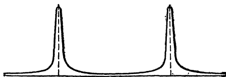
Рис. 72. Распределение интенсивностей при сложении бесконечного числа колебаний.
