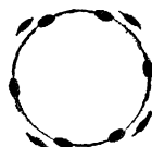
Рис. 110. Рентгенограммас прокатанной пластинки (волокнистая структура).
