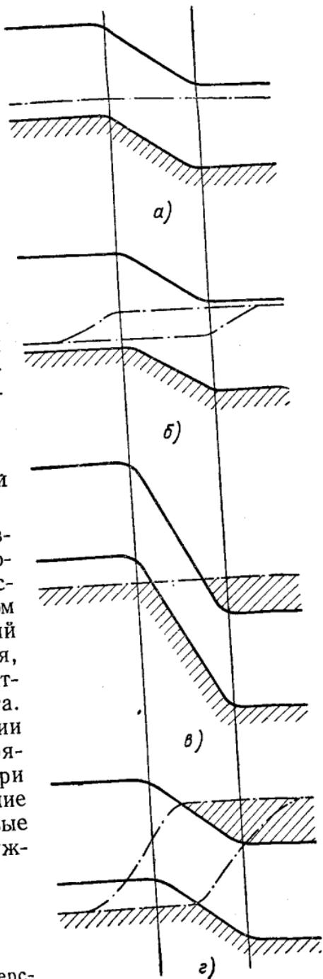
Рис. 9.6. Схема создания инверсной заселенности при помощи  $p-n$  перехода.
